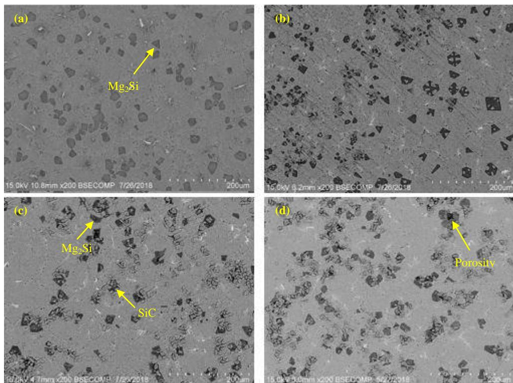
**Figure 1:** SEM micrographs of hybrid MMCs with SiC content;(a) 0 wt.% SiC (b) 5 wt.% SiC © 10 wt.% SiC (d) 15 wt.% SiC
